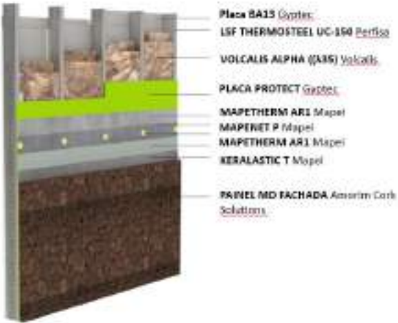
SISTEMA DE FACHADA LEVE SKINIUM WS3 MD Fechada à Vista
