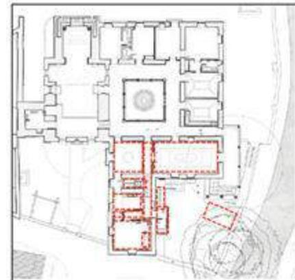
**Planta do Piso Superior com indicação das principais transformações ocorridas na transição do séc.XIX para o séc.XX**
