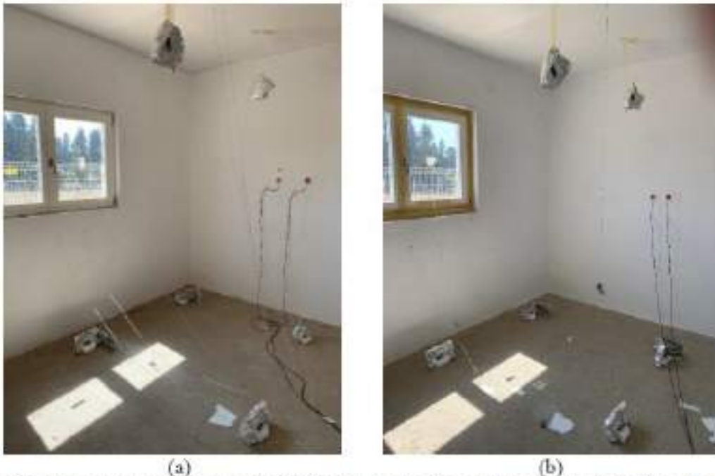
Fig. 5 : Quadro de instrumentação atual (01/09/2019) das células experimentais: (a) Célula experimental LSF, (b) Célula experimental Tradicional
